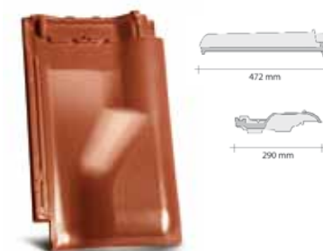
větrací taška - větrací průměr cca: 23 cm 2 - hmotnost 1 ks cca: 4,5 kg
