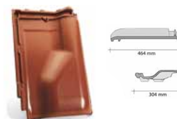
větrací taška - větrací průměr cca: 23 cm 2 - hmotnost 1 ks cca: 3,9 kg
