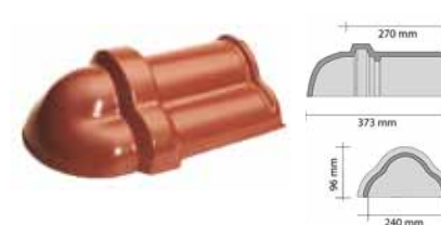
ukončovací hřebenáč nárožní hmotnost 1 ks cca: 3,4 kg
