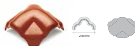
napojovací hřebenáč Y univerzální - hmotnost 1 ks cca: 4,8 kg
